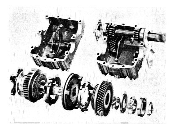
4. MULTIPLE-DISC CLUTCH INCLUDING OPERATION - POWER TRAIN
